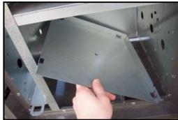
Prenez les planchers inférieurs, étiquette vers le bas et les inclinez à 45° afin de les mettre en place dans l'ensemble.
