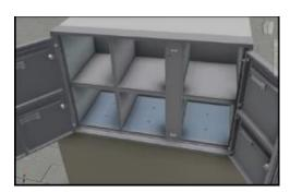
2. Dans le fond de l'ensemble, repérez les trous de perçage prévus (2 par alvéole) et tracez au travers l'emplacement des trous de fixation. Retirez l'ensemble du muret, percez les trous et mettez en place les chevilles.
