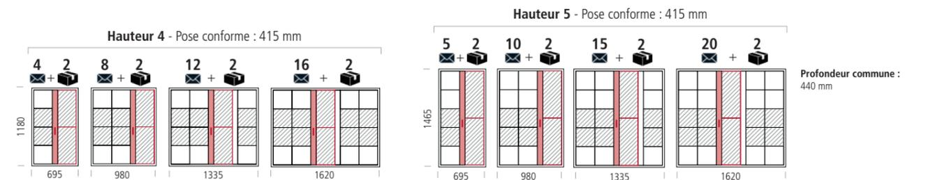
Pour une conformité à la loi handicap, respectez les hauteurs de pose indiquées sur les schémas du bas des ensembles au sol fini. Les zones grisées correspondent aux boîtes situées dans la zone d'ergonomie (0,90 - 1,30 m).
