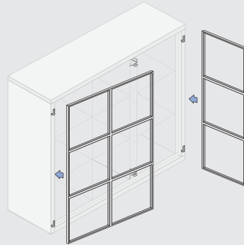
installation des guides de fermeture et pose des vantaux
