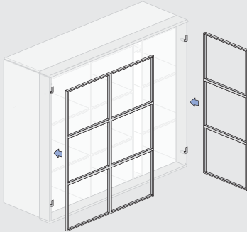
installation des vantaux
